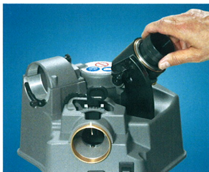
Régler l'angle de pointe 118°-140° Processus d'affûtage sur roulement axial et radial
