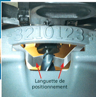
Positionnement du foret y compris du réglage de la dépouille arrière
