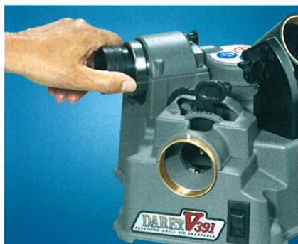
Amincissement avec pré-réglage, profondeur d'amincissement et largeur du dos du foret
