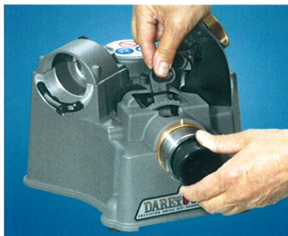
Positionnement du foret y compris du réglage de la dépouille arrière
